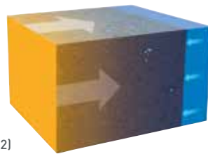
2) PENETRON aplicado al lado positivo o negativo.
